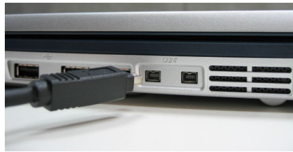
Anschließen eines 4-Pol-zu-4-Pol-IEEE-1394-Kabels an einen Notebook-Computer
