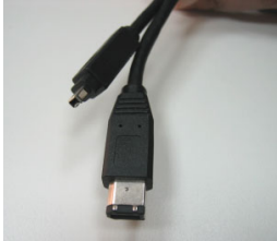
Anschließen eines 4-Pol-zu-6-Pol-IEEE-1394-Kabels an einen Desktop-Computer
