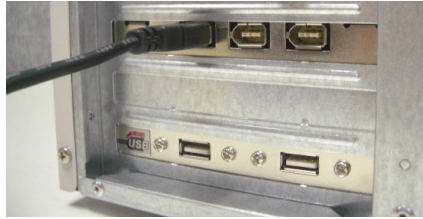
Anschließen eines 4-Pol-zu-6-Pol-IEEE-1394-Kabels an einen Desktop-Computer
