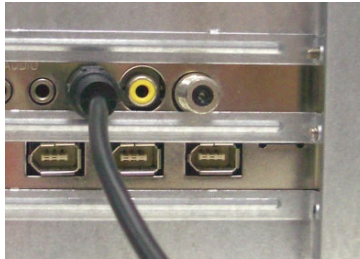
Anschließen der S-Video-Quelle an die Aufnahmekarte
