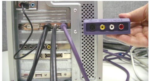
Verbindung mit spezialisierter TV- Aufnahmekarte
