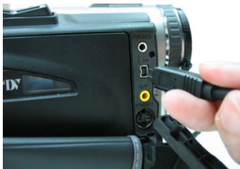
Anschließen des IEEE-1394-Kabels an den DV-Camcorder
